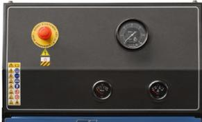
Die Steuertafel M80 hat zwei Funktionen: Sie dient als Klemmenblock für den Anschluss einer Schaltanlage und als direkt ablesbare Instrumententafel, über deren Anzeigeelemente die Grundparameter des Stromerzeugers auf einen Blick kontrolliert werden können. Diese umfasst folgende Funktionen:
